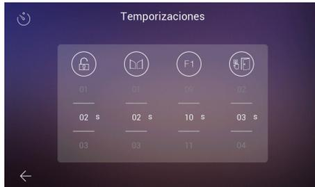
Una temporización 00 indica que se deshabilita esa salida y por tanto no se puede seleccionar. En el caso de la salida F1, un valor T significa modo de funcionamiento 'toggle' y el estado conmuta cada vez que se pulsa la tecla.
