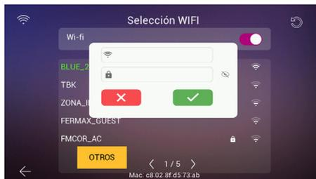
*Nota: En la parte inferior se muestra la dirección MAC del monitor por si se quiere asignar una dirección IP fija en el router.*
