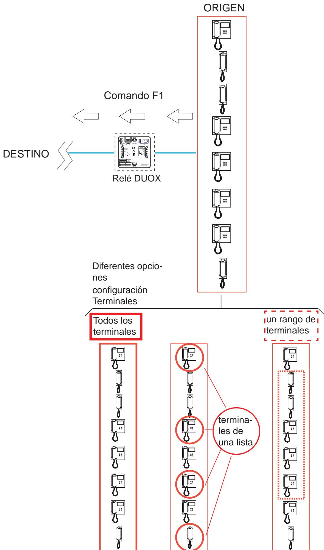
**Configuración función.****Primer paso: Configuración de comando.**
