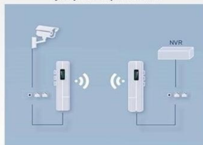
Punto a punto para transmisión de imágenes en sistema CCTV
